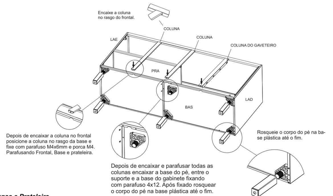
Depois de encaixar a coluna no rasgo do frontal posicione a coluna no rasgo da base e fixe com parafuso M4x6mm e porca M4. Parafusando Frontal, Base e prateleira.
